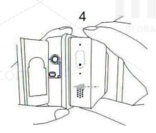
Подберите положение для объектива камеры в водонепроницаемом боксе, чтоб объектив встал точно в бокс
