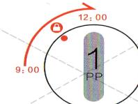
03 После включения, нажмите кнопку "Выбор" и выберите новый фильтрующий патрон над которым будет гореть индикатор. Нажмите и удерживайте кнопку "Сброса" в течении 3 секунд и после того, как вы услышите звуковую сигнализацию, индикатор потухнет. Сброс настроек успешно завершен (рис 4)
