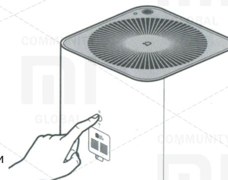
После замены фильтра включите воздухоочиститель. Нажмите и удерживайте кнопку сброса, пока не услышите характерный звуковой сигнал. Сброс времени эксплуатации фильтра успешно выполнен.
