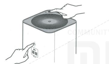
Если ваш смартфон не подключается к воздухоочистителю, пожалуйста, нажмите одновременно на кнопки «переключение режимов» и «включения / выключения дисплея» и удерживайте их в течение 5 секунд, пока не услышите характерный звуковой сигнал, указывающий на успешный сброс настроек Wi-Fi .
