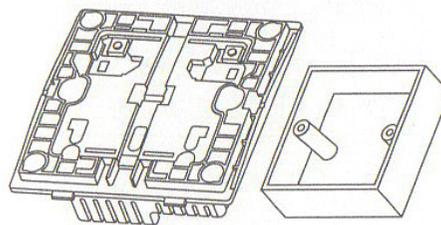
3. Прочно прикрутите настенный выключатель к клеммной коробке, используя винты.
